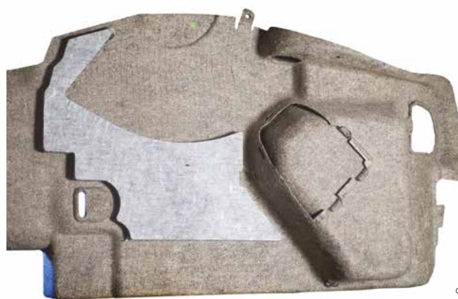
Intérieur de portière de voiture en fibre de lin et polypropylène
